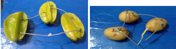
Hình 12. So sánh độ sáng của đèn Led khi giảm số lượng khế và khoai tây
