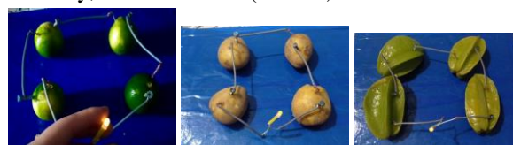
Hình 11. So sánh độ sáng của đèn Led pin chanh, khế và khoai tây khi cùng số lượng
