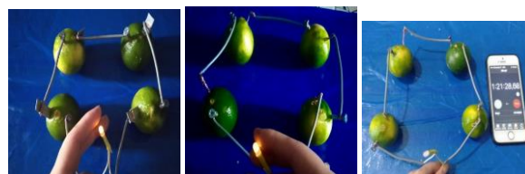
Hình 7. Đo độ sáng và thời gian sáng của đèn Led
