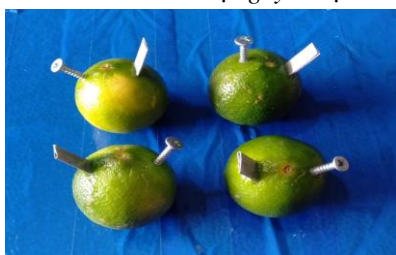
Hình 4. Gắn thanh Cu và Al vào quả chanh
